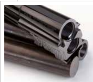
Canne in acciaio speciale trilegato, ricavate da foratura barra. Anima e camere cromate internamente, per assicurare maggiore durata e resistenza alla corrosione e rosate meglio distribuite. Special three-alloy steel barrel machined out of bored bars. Internally-chromed bore and chambers for improved lifespan and corrosion resistance and better-distributed shot patterns. Canons en acier spécial à triple alliage, usinés à partir du percement de la barre. Ame et chambres chromées intérieurement pour garantir une meilleure durée et résistance à la corrosion et une meilleure régularité de gerbe.
